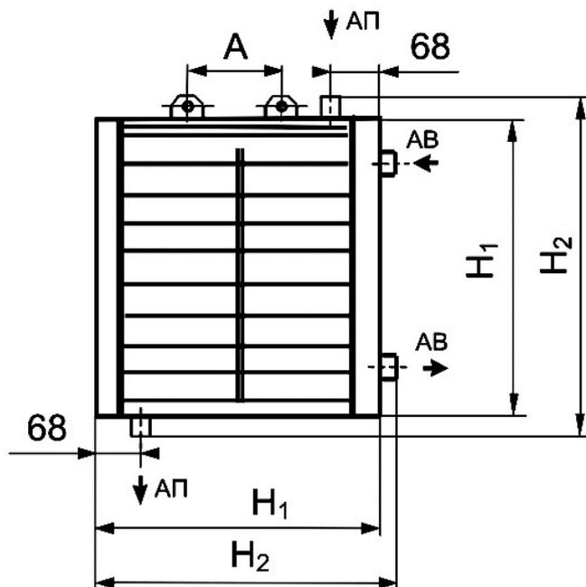
Агрегат воздушно-отопительный **АП-5-40** предназначен для воздушного отопления помещений промышленного, сельскохозяйственного и гражданского назначения.
