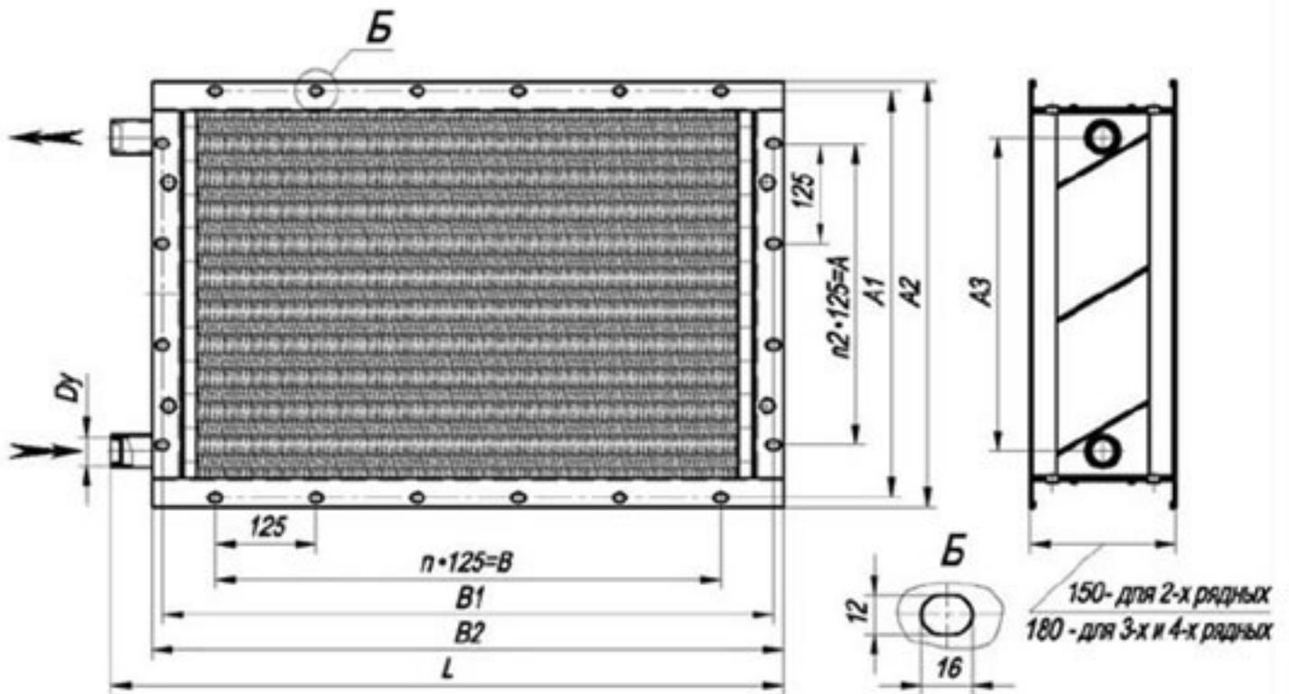
Рисунок 1 - размеры, мм
