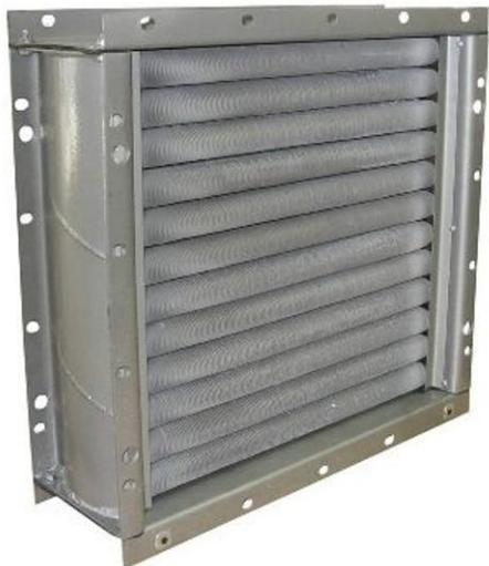
**Калорифер КСк 2-3** с алюминиевым спирально-накатным оребрением предназначен для нагрева воздуха в системах отопления, вентиляции, кондиционирования, сушки различных материалов, а также для использования в составе различного технологического оборудования.
