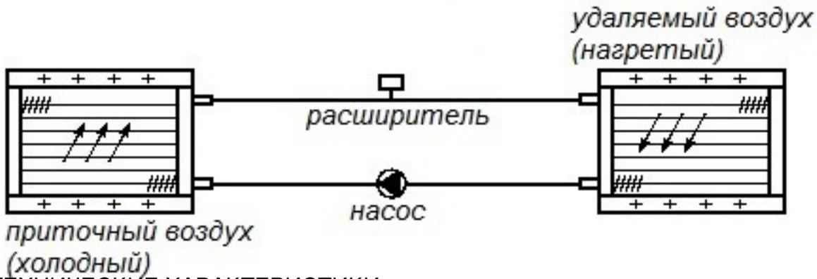
~~ТЕХНИЧЕСКИЕ ХАРАКТЕРИСТИКИ:~~ Технические характеристики в таблице приведены для режима:  $Q_{max} = 20,6 \text{ кВт}$ , диаметр:  $53,5^{+4,28}$
