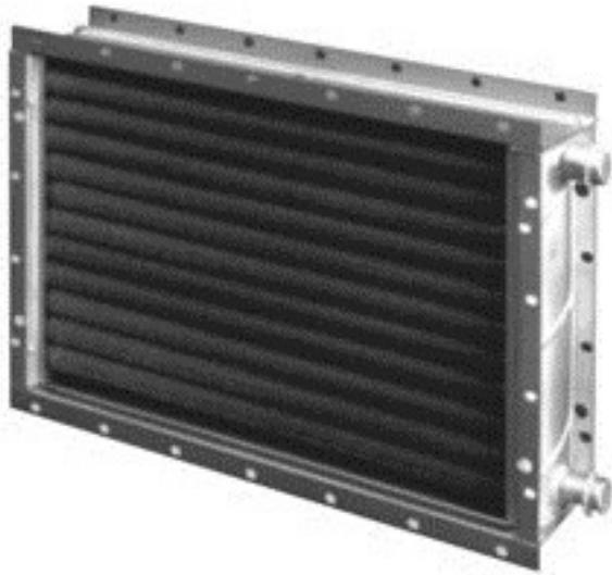
Воздухонагреватель **ВНП113ФБ-406** разработан в замен ранее выпускаемому пластинчатому калориферу КФБ-6 и предназначен для нагрева или охлаждения воздуха в системах отопления, вентиляции и кондиционирования при помощи сухого перегретого водяного пара.
