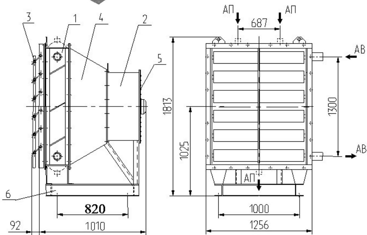
Агрегат воздушно-отопительный АВ-16-180 УЗ предназначен для воздушного отопления помещений промышленного, сельскохозяйственного и гражданского назначения.
