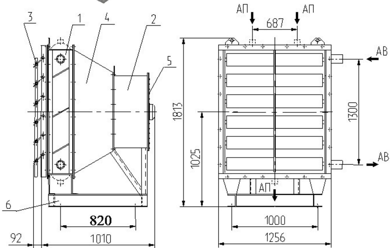
Агрегат воздушно-отопительный **АП-16-260 УЗ** предназначен для воздушного отопления помещений промышленного, сельскохозяйственного и гражданского назначения.
