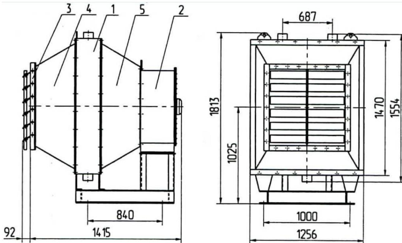
Агрегат **АП-21-300 УЗ** предназначен для воздушного отопления помещений промышленного, сельскохозяйственного и гражданского назначения.
