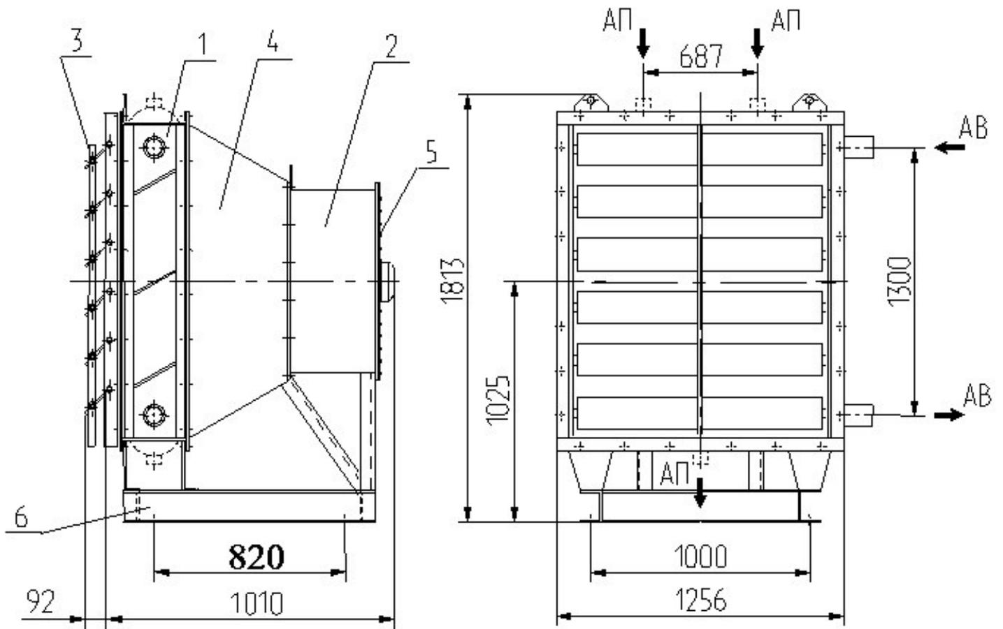
Агрегат воздушно-отопительный АП-25-350 У3 по техническим условиям ПАО «Т Плюс»
