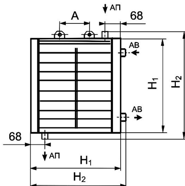
**Агрегат воздушно-отопительный АП-3-25** предназначен для искусственного перемещения и нагрева рециркуляционного воздуха в зданиях промышленного, сельскохозяйственного и гражданского назначения при помощи сухого насыщенного водяного пара в условиях умеренного климата, категории размещения 3 по ГОСТ 15150-69.
