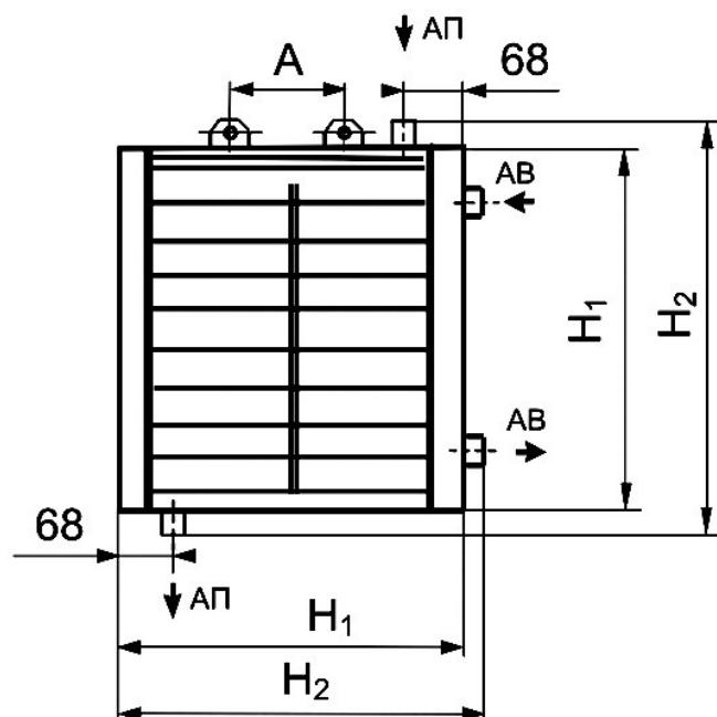
**Агрегат воздушно-отопительный АП-3-30** предназначен для искусственного перемещения и нагрева рециркуляционного воздуха в зданиях прошитленного, сельскохозяйственного и гражданского назначения при помощи сухого насыщенного
