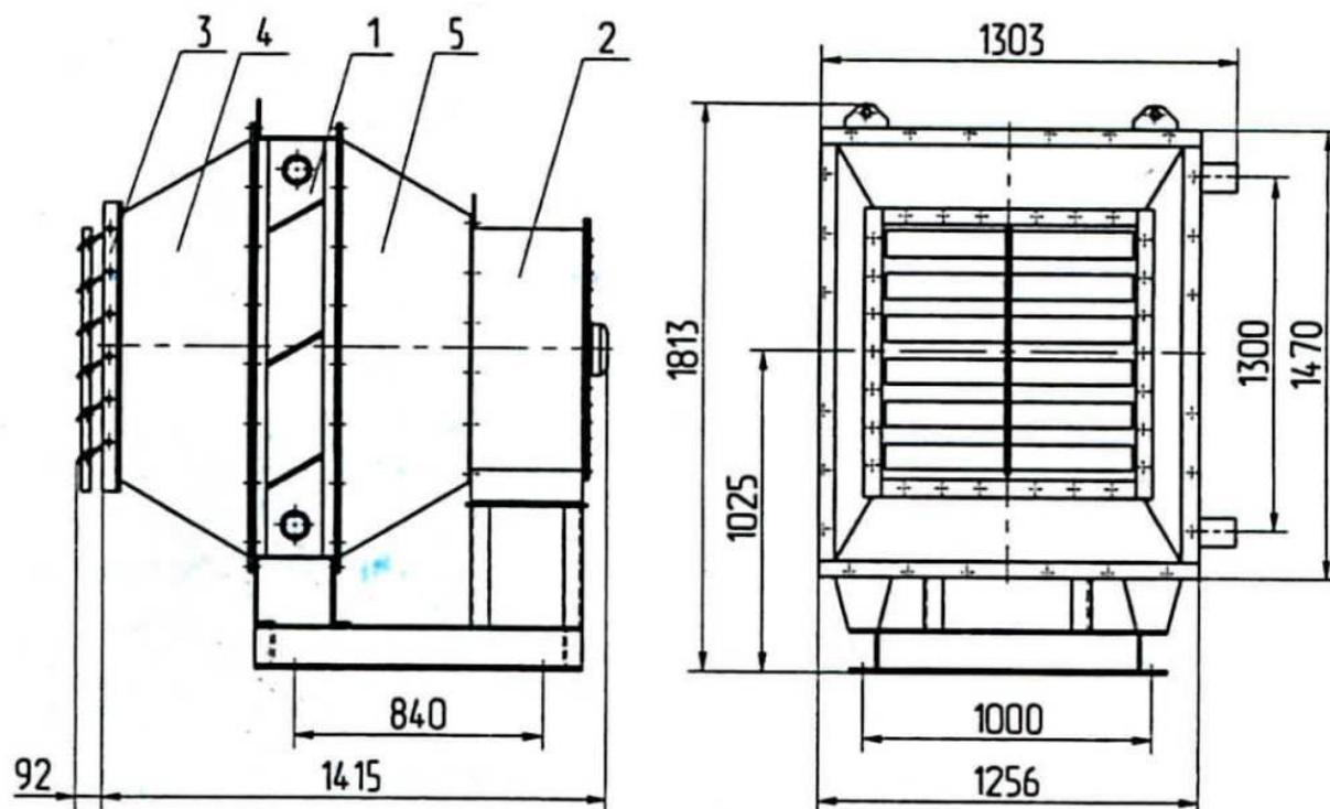
**Агрегат воздушно-отопительный АВ-21-300** используется для искусственного перемещения и нагрева рециркуляционного воздуха (воздуха помещения) в зданиях промышленного и производственного назначения при помощи горячей воды.
