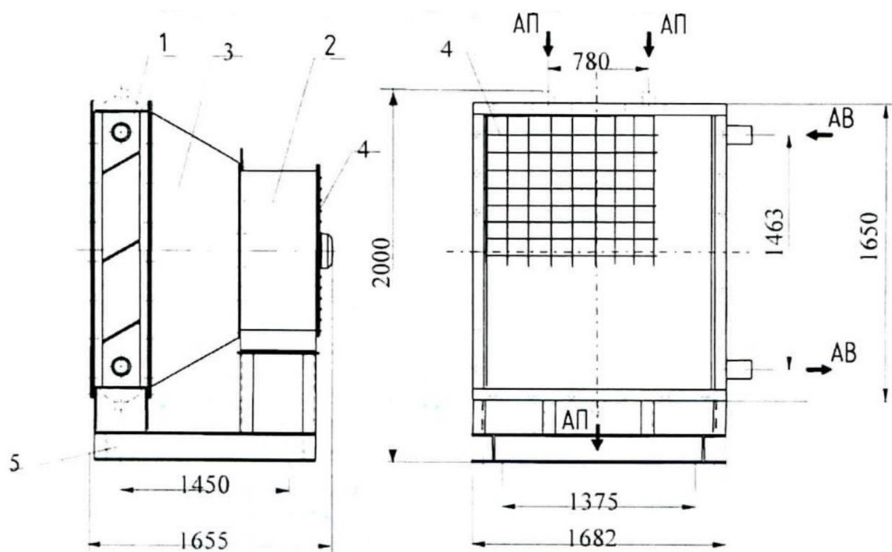
Агрегат АВ-33-420 используется для искусственного перемещения и нагрева рециркуляционного воздуха в зданиях промышленного и производственного назначения при помощи перегретой воды.
