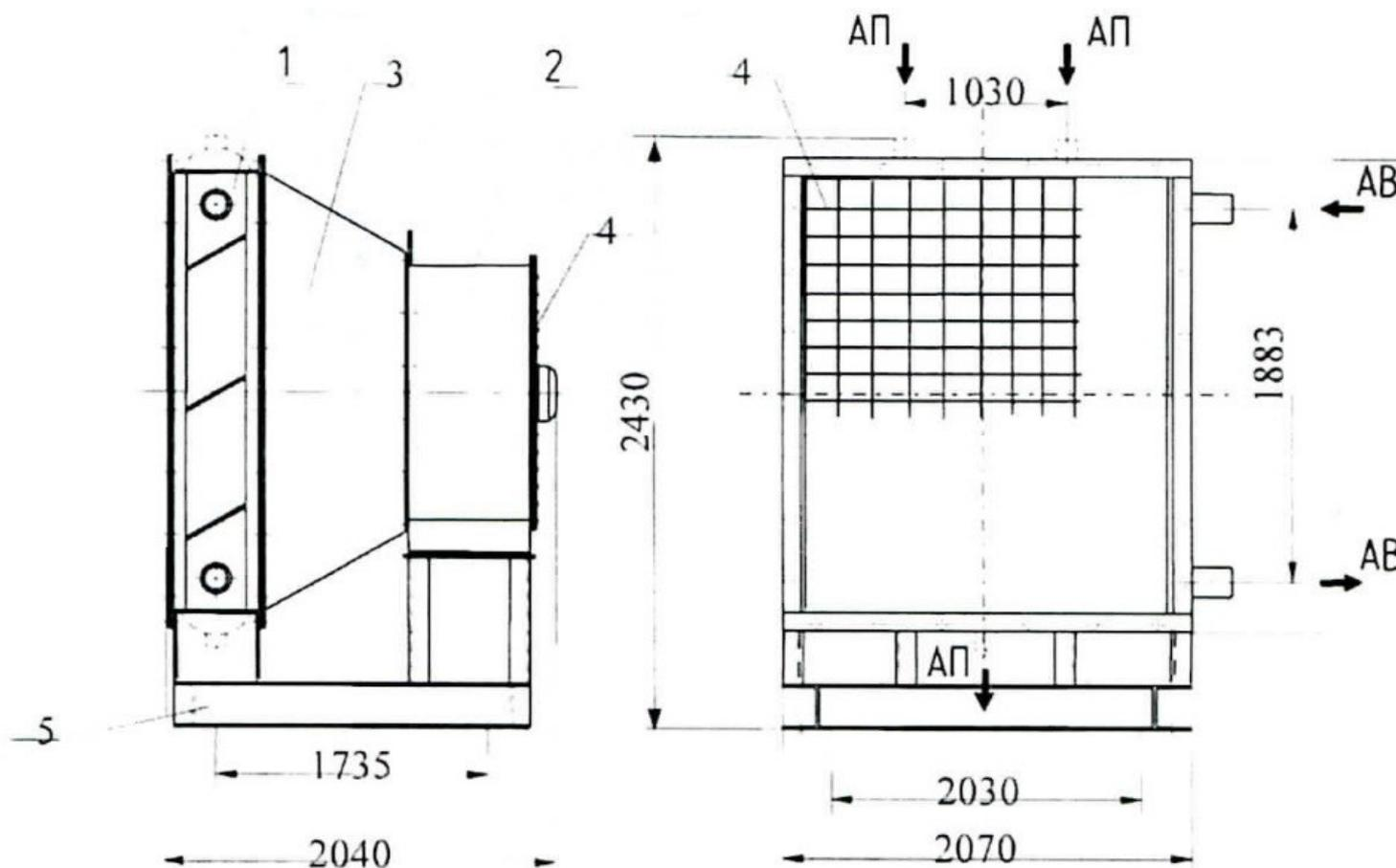
**Агрегат воздушно-отопительный АВ-49-640** предназначен для воздушного отопления помещений промышленного, сельскохозяйственного и гражданского назначения.
