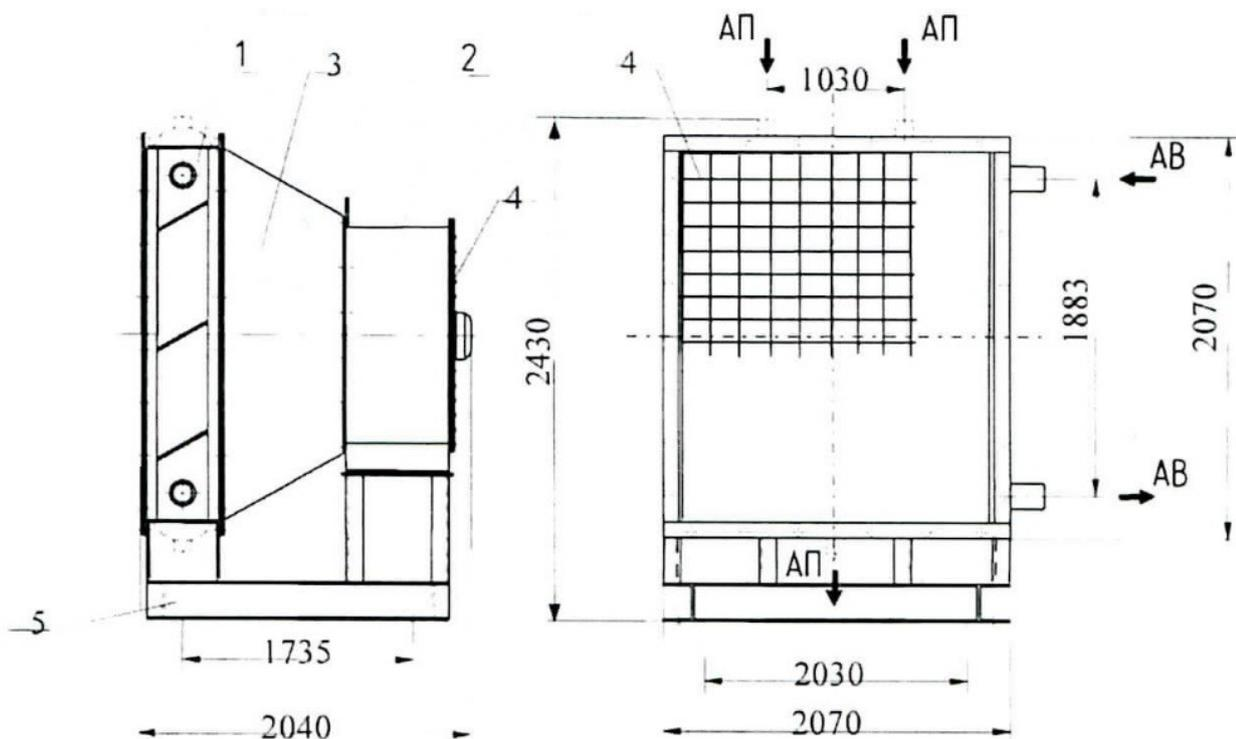
Агрегат **АВ-49-740** используется для искусственного перемещения и нагрева рециркуляционного воздуха (воздуха помещения) в зданиях промышленного и производственного назначения при помощи горячей воды.
