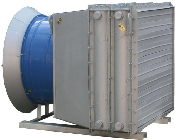
**Агрегат воздушно-отопительный АО2-7-85** осуществляет нагрев воздуха, не содержащего липких веществ и волокнистых материалов с помощью теплоты горячей и перегретой воды и предназначен для воздушного отопления производственных помещений категорий Г и Д по СНиП 2.09.02-85.
