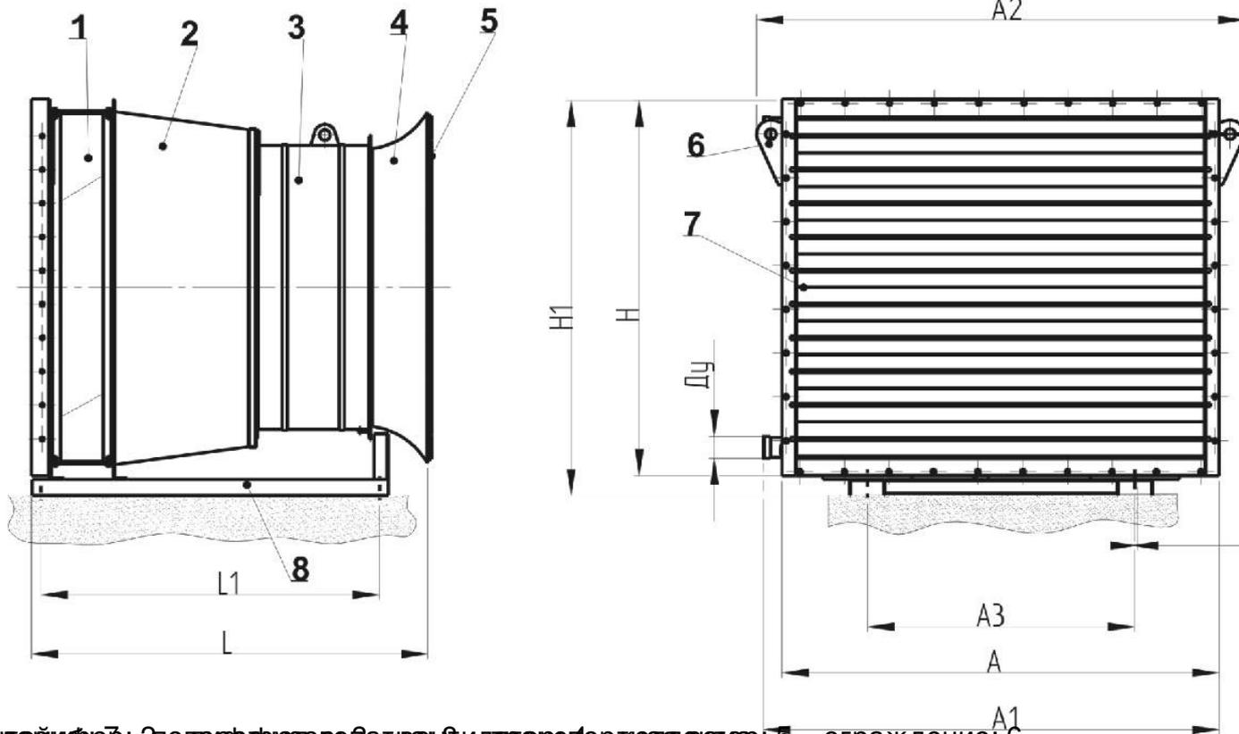
1 – левая панель; 2 – радиатор; 3 – верхняя опора; 4 – правая панель; 5 – ограждение; 6 – подключение к системе отопления; 7 – радиатор. Максимальная температура теплоносителя 110°C, расход теплоносителя 1,5 м³/ч, расход воздуха 10 м³/мин.
