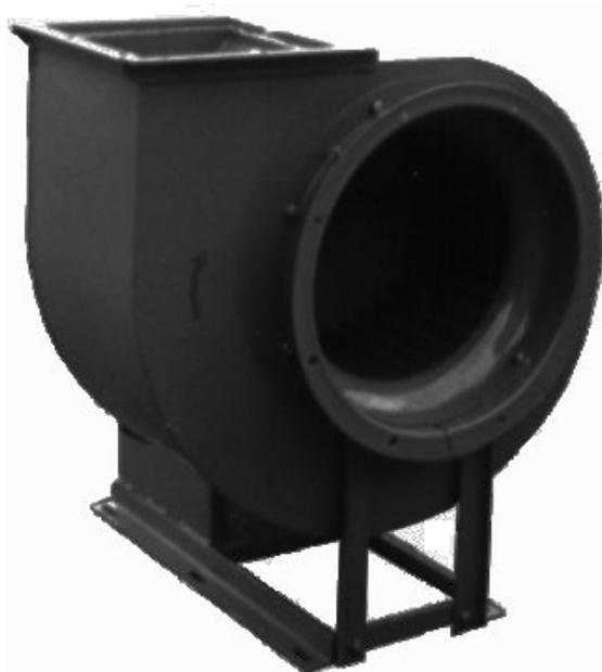
**Вентиляторы радиальные** среднего давления **ВР-285-44** предназначены для перемещения воздуха и других газовых смесей с температурой не выше плюс 80 °С, не содержащих липких веществ и волокнистых материалов, в системах кондиционирования воздуха и вентиляции производственных, общественных и жилых зданий, а также для других целей в условиях умеренного (У) климата категории размещения 3 по ГОСТ 15150-69.
