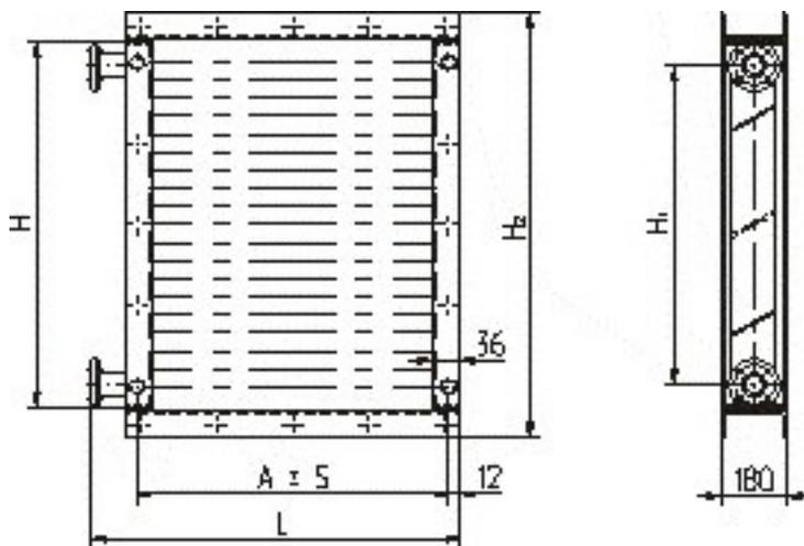
**Теплообменник ВНВ113-15.12.01 У3** предназначен для комплектации центральных кондиционеров КТЦЗ производительностью по воздуху от 10000 до 250000 м<sup>3</sup>
