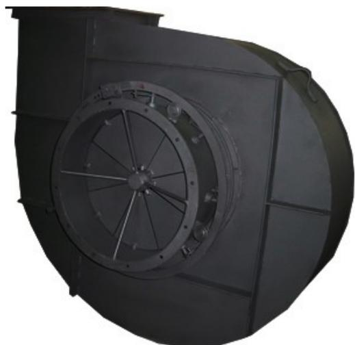
**Вентилятор ВДН-8** с направляющим аппаратом используется для подачи воздуха в топку котельных агрегатов и другие технологические установки.
