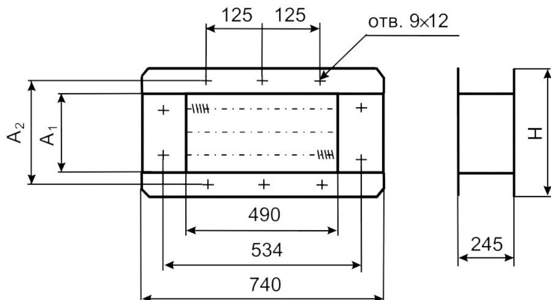
**Воздухонагреватель электрический ВЭ-15-02 УХЛ4** предназначен для комплектации воздухонагревательных установок серии УВЭ, применяемых для отопления и вентиляции помещений промышленного, сельскохозяйственного, коммунального и культурного назначения, а также для других установок, взамен электрокалориферов серии СФО-1Т, а также в качестве самостоятельного изделия для воздушного отопления помещений.
